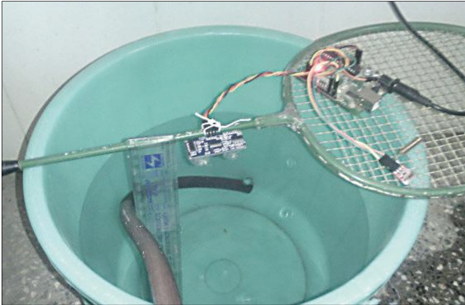
Figuur 3: Badmintonrackets zijn heel handig om snel een testsituatie op te bouwen.
